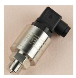
CYB161 高精度压力变送器是专门针对高精度压力测量领域的应用而开发的一种压力测量产品。采用国际上先进的压力传感器制造技术,融合特殊的补偿放大电路,组成性能优越的压力变送器。整个产品经过了元器件、半成品及成品的严格测试及老化筛选,性能稳定可靠。它具有宽温区范围补偿,保证产品精度高、温度影响小、长期稳定性好、耐恶劣环境等特点。一体化结构,防护性能优越,优良的可靠性,特别适合需要对流体微小压力进行高精度检测和控制的领域。提供表压和负压两种种形式。量程可由用户指定。应用领域:气象、窑炉、医疗、塑料和玻璃工业吹塑机器、流量控制;石油、化工、冶金、电力、水文、工业控制等对现场微小压力进行监测和控制的领。
