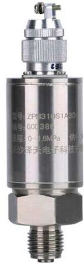
CYB330 溅射膜油压压力变送器的核心部件为溅射薄膜压力传感芯片，融合高可靠的专用信号处理电路，采用激光焊接精密封装于不锈钢壳体内，组成性能优越的压力变送器。产品出厂前经过压力疲劳冲击，高低温循环老化和温度补偿，确保产品稳定可靠。现已广泛应用于航空航天、石油、化工、交通、能源、轻纺、机械、电力、冶金、汽车、供排水、环境、医药、卫生、教学科研及其它需要压力测量与控制的行业或领域。
